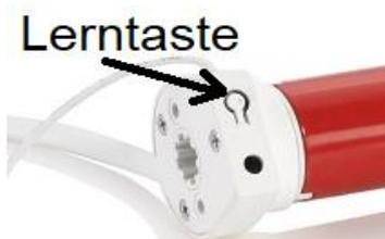
Halten Sie die **Lerntaste** am Motorkopf mit einem Gegenstand so lange gedrückt, bis der Antrieb 4 Mal mit einer kurzen Auf-/Ab-Bewegung und 4 Pieptönen reagiert. Lassen Sie die Lerntaste wieder los. Der Antrieb ist nun wieder auf Werkseinstellung gesetzt. Alle Verbindung und Einstellungen sind gelöscht.
