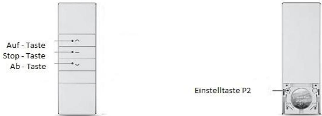
Mit SIS1600 können Sie entweder einen einzelnen Antrieb oder eine Antriebsgruppe (bis zu 20) der SIRO bidirektionalen Antrieben ansteuern.
