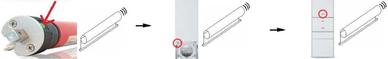
1. Halten Sie die **Lerntaste** am Motorkopf so lange gedrückt, bis der Antrieb (in der Regel nach 3 Sekunden) mit einem Piepton und einer Auf-/Ab-Bewegung reagiert, dann lassen Sie die Lerntaste sofort wieder los.
