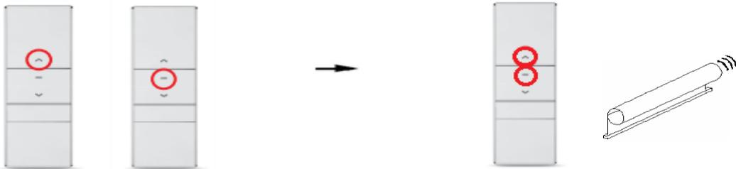
Drücken Sie die **Auf-Taste** und lassen Sie den Antrieb nach oben fahren. Drücken Sie die **Stop-Taste**, wenn der Antrieb die gewünschte obere Endlage erreicht hat.
