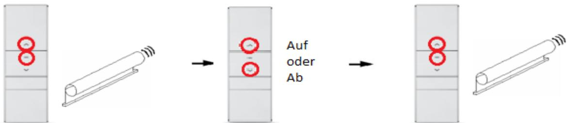
Halten Sie die **Auf-** und **Stop-Taste** gleichzeitig gedrückt bis der Antrieb mit 1-maliger Auf- /Ab- Bewegung und einem langen Piepton reagiert. Lassen Sie die Tasten wieder los.
