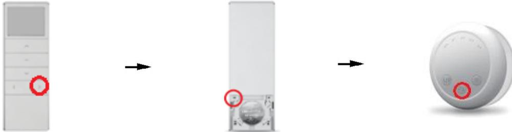
1. Mit der Kanal-Taste legen Sie einen Kanal fest. Auf diesem Kanal befinden sich derjenige Antrieb, mit dem Sie mittels Sonnensensor steuern möchten.
