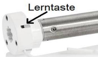
Halten Sie die **Lerntaste** am Motorkopf mit einem Gegenstand so lange gedrückt, bis der Antrieb 3 Mal kurzer Auf- /Ab- Bewegungen reagiert. Lassen Sie die Lerntaste sofort wieder los. Die Drehrichtung wird damit geändert.
