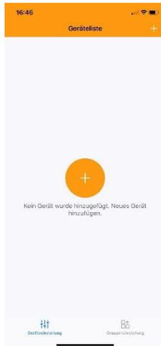
Wählen Sie in der "+", um ein Gerät hinzuzufügen. Die App beginnt mit dem Suchen des Gerätes. Geben Sie dann das Gerätekennwort ein, um die Verbindung mit dem Gerät herzustellen. Anfängliches Passwort: 8888.
