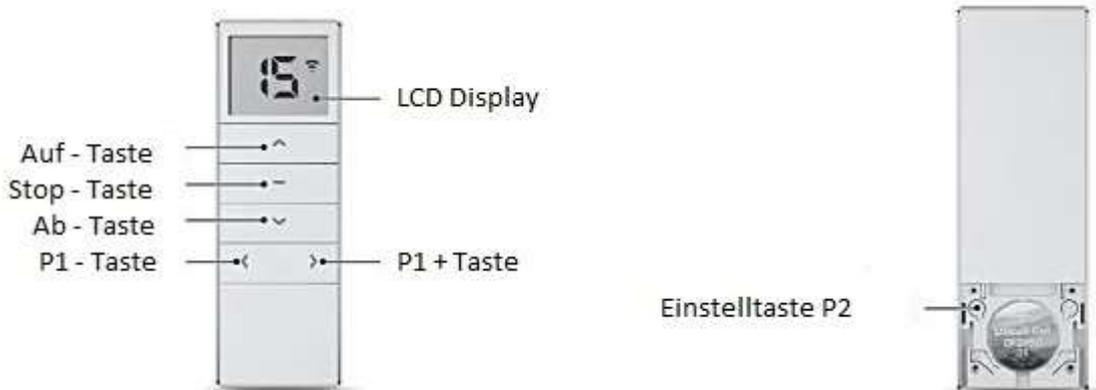
1. Testen Sie die Verbindung zwischen Handsender und dem Motor, indem Sie durch Betätigung der **Auf-** bzw. **Ab-Taste** des Senders den Antrieb auf- bzw. abfahren lassen. Besteht die Verbindung, gehen Sie bitte direkt zu Punkt 3.3 über.
