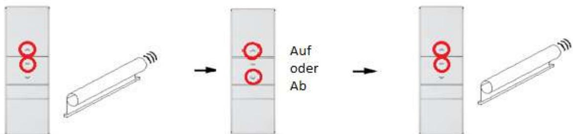
1. Halten Sie die **Auf- und Stop-Taste** gleichzeitig gedrückt bis der Antrieb mit einmaliger Auf- /Ab-Bewegungen reagiert. Lassen Sie die Tasten wieder los.
