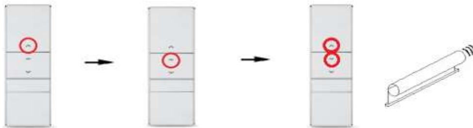
1. Drücken Sie die **Auf-Taste** und lassen Sie den Antrieb nach oben fahren.
