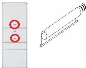
Halten Sie die **Auf-** und **Ab-Taste** gleichzeitig gedrückt, bis der Antrieb mit kurzen Auf-/Ab-Bewegungen reagiert. Lassen Sie die Taste wieder los. Somit ist die Drehrichtung des Antriebes geändert.
