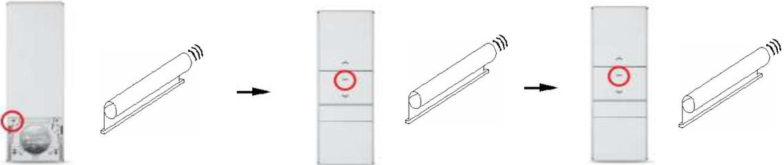
1. Fahren Sie den Antrieb zur gewünschten Mittelposition. Drücken Sie einmal **P2-Taste**. Der Antrieb bestätigt mit einer Auf-/Ab-Bewegung.
