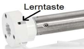
Halten Sie die **Lerntaste** am Motorkopf mit einem Gegenstand so lange gedrückt, bis der Antrieb 3-mal kurzer Auf- /Ab- Bewegungen reagiert. Lassen Sie die Lerntaste sofort wieder los. Die Drehrichtung wird damit geändert.
