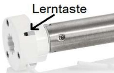
Halten Sie die **Lerntaste** am Motorkopf mit einem Gegenstand so lange gedrückt, bis der Antrieb nur 4-mal mit einer kurzen Auf-/Ab-Bewegungen reagiert. Lassen Sie die Lerntaste wieder los. Somit ist der Antrieb auf Werkseinstellung versetzt. Alle Verbindung und Einstellungen sind gelöscht.
