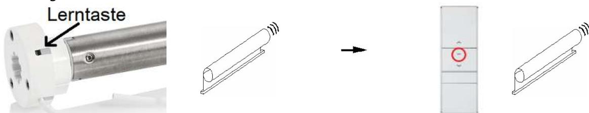
1. Halten Sie die **Lerntaste** am Motorkopf mit einem Gegenstand so lange gedrückt, bis der Antrieb nur einmal (in der Regel nach 3 Sekunden) mit einer kurzen Auf- /Ab-Bewegungen reagiert. Lassen Sie die Lerntaste sofort wieder los.
